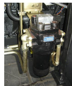
Рис. 4-11. Фильтр контура высокого давления гидравлической системы
